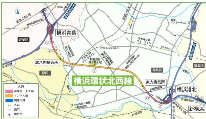
横浜環状北西線は、東名高速道路と横浜北線および第三京浜道路を結ぶ、全長約7.1Kmの自動車専用道路です。
